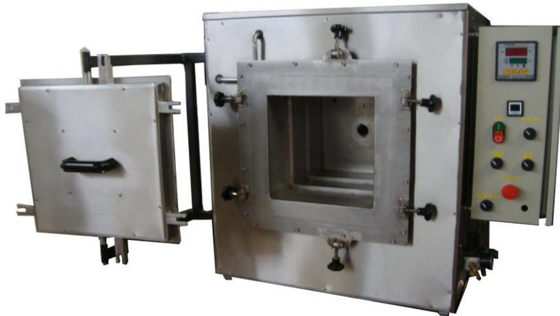
Fornos de câmara para: tratamentos em atmosfera controlada, (N<sub>2</sub>, Ar e outros) recozimento, endurecimento, têmpera e envelhecimento (tratamentos térmicos de metalurgia).
